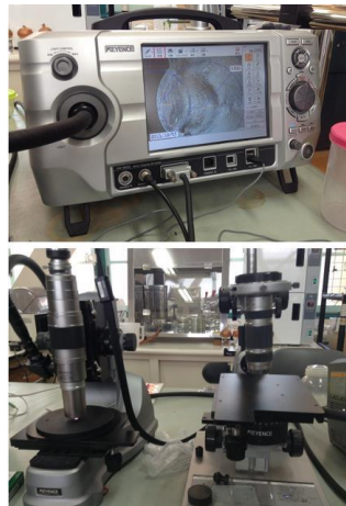
【図7】 顕微鏡 10～200 倍の実体顕微鏡（右）、500～5000 倍の光学顕微鏡（左）。
