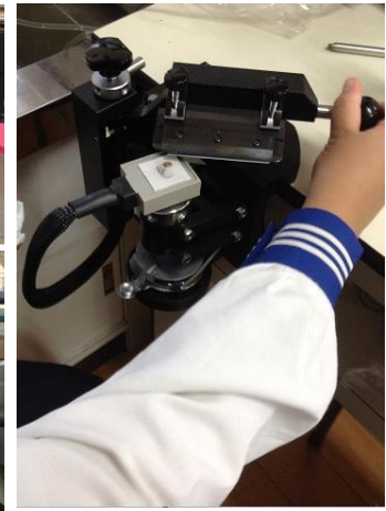
【図8】凍結マイクローム 凍結した試料を5～40 ミクロンの幅で切断可。
