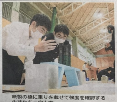
紙製の橋に重り載せて強度を確認する生徒たち=宇土市
