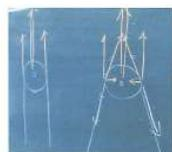
右側の図のほうが左側の図に比べ滑車の中心に余計な力が加わり持ち上げるのに時間がかかるため平行に調節した。
