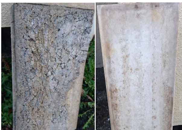
図 6 ざらざらしたコンクリート(左)とつるつるしたコンクリート(右)
