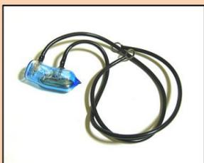
容器内に少量の水銀が封入されている。容器が傾くことで重力によって水銀が移動し、端子と水銀が接触した場合に通電状態となる。接触抵抗が非常に少なく、さらにチャタリングが発生しないという特徴がある。現在は製造中止。
