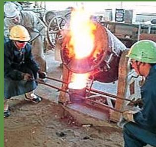
高温にして溶かした金属を鑄型に流し込み、作っていきます。
