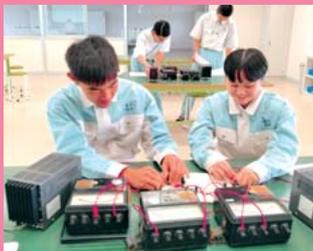
半導体デバイスの代表格、トランジスタの静特性を測定し、動作原理について理解を深めます。
