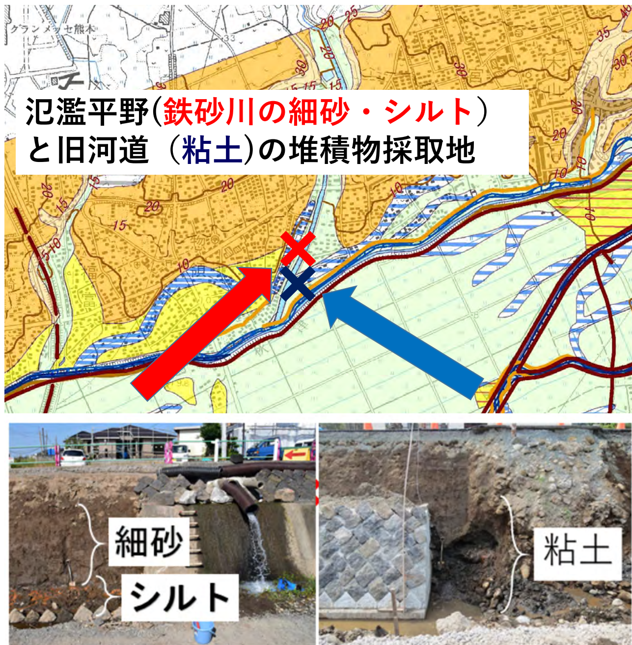
図 20 鉄砂川護岸工事現場の氾濫平野と旧河道の断面と堆積物採取地点
