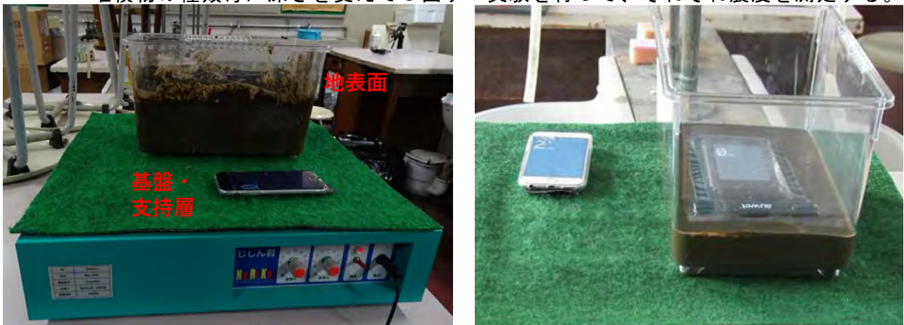
図 22 地震発生装置と実験の様子
