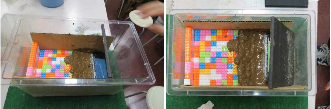
図 28 実験で崩れた堆積物を支える発泡スチロール板（擁壁）
